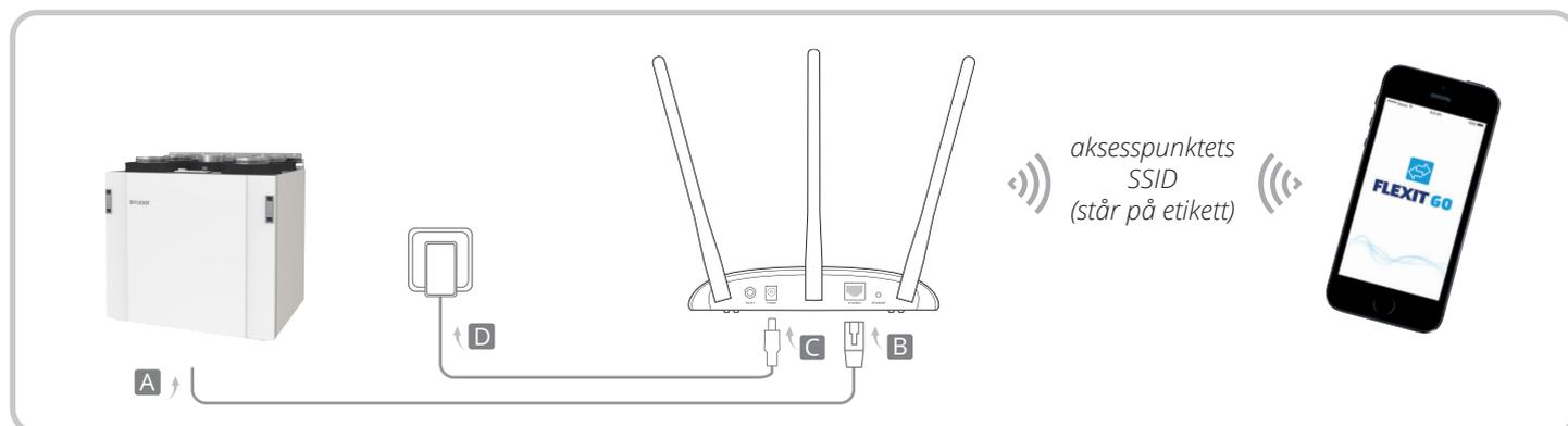
1. Følg trinn A til D i diagrammet for å koble til aksesspunktet.
