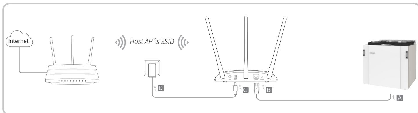
1. Koble til aksesspunktet i henhold til trinn A til D i diagrammet.
