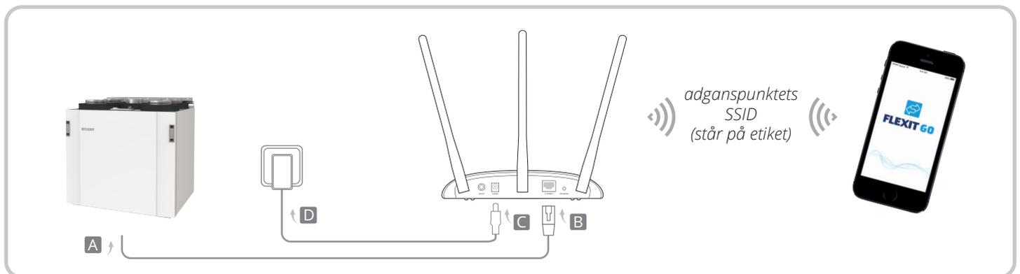
1. Opret forbindelse til adgangspunktet som vist i trin A til D i diagrammet.
